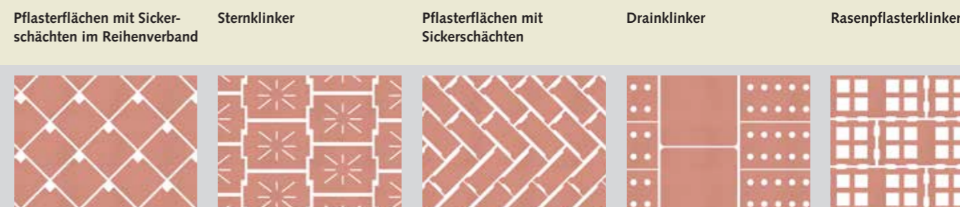
Abb. 6-3: Verschiedene Pflasterklinkerformate für versickerungsfähige Pflasterflächen
