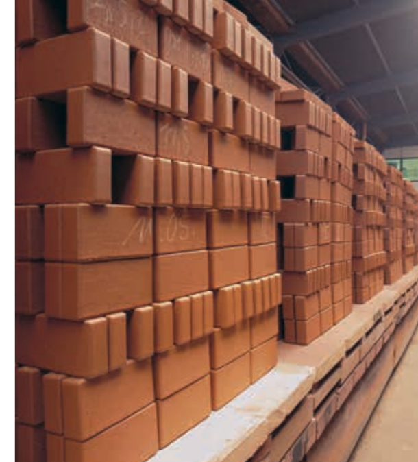
Gebrannte Pflasterklinker nach Verlassen des Ofens
