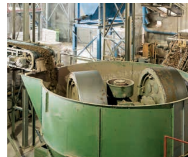
Kollergang, zwei schwere Walzen zerkleinern den Ton
